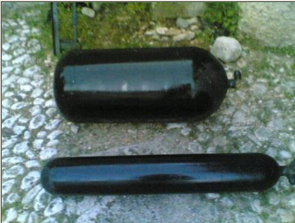
Serbatoi di metano compresso
